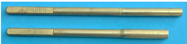
Slika 8: Izgled epruveta pre i nakon vučenja od materijala CuZn37
