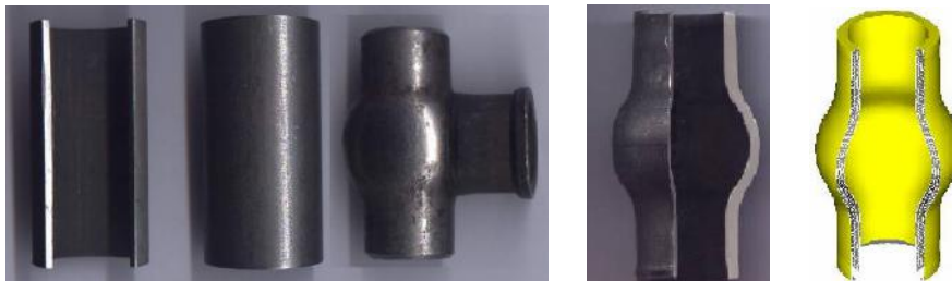
Slika 1. Cijevni pripremak, gotov deo, i cevni obradak, fizički model i FE model
