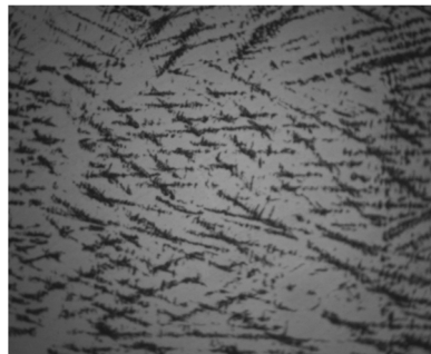
Medjusloj - Iglice martenzita u austenitnoj osnovi
