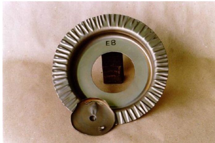
Slika 4. Izgled obratka dobijen elektrohidrauličnom metodom
