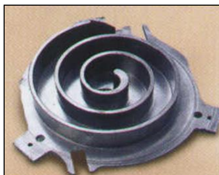
Slika 3. Spirala u ravni izrađena pomoću podeonog aparata sa automatskim pogonom
