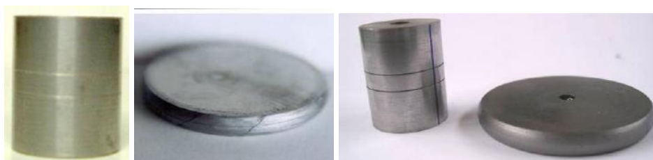
Slika 3: Uzorci pre i posle sabijanja ravnim pločama - a) puni valjci, b) šuplji valjci
