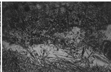
Slika 5. Mikrostruktura ZUT 3 – martenzitna + zaostali austenit + medjufazne strukture
