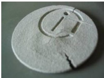
c) pukotine nastale usled naglog sušenja
