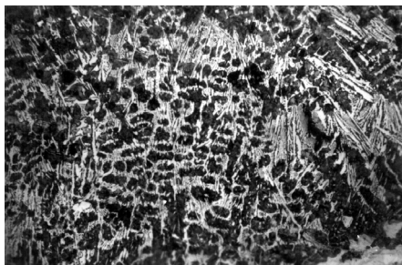
Slika 4. Mikrostruktura ZUT 1 - ledeburitna + zaostali austenit
