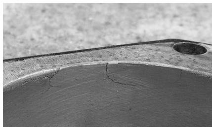
Slika 5: Pojava pukotina i odvajanje prevlake
