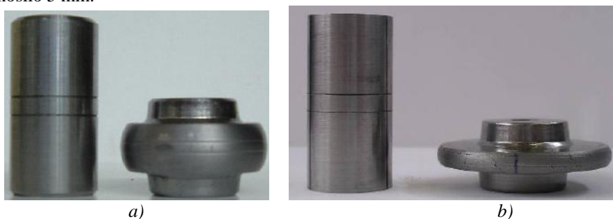
Slika 4. Uzorci pre i posle sabijanja izdubljenim alatima - a) puni valjci, b) šuplji valjci
