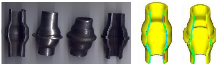
Slika 2. Defektni cijevni elementi, fizički modeli i FE model
