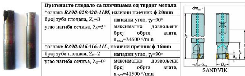
Slika 2. Izgled vretenastih glodala sa pločicama od tvrdog metala
