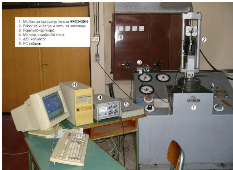
Slika 6: Izgled mernog lanca za kompjutersku akviziciju podataka
