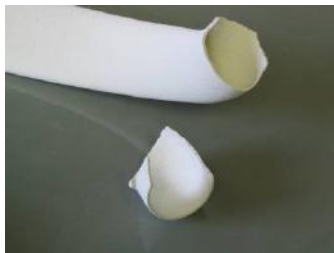
a) deo oštećen pri grubom odstranjivanju
