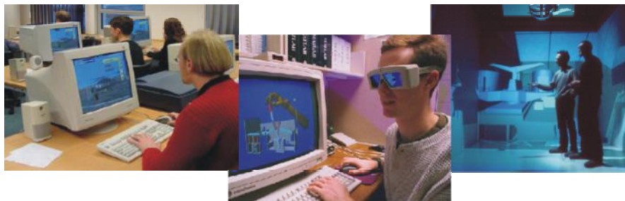
Slika 2: Ilustracije neimerzivnog, poluimerzivnog i imerzivnog VR sistema
