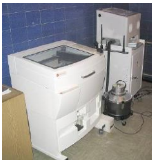
Slika 4. ZCorporation ZPrinter 310 System u prostorijama Centra za informacione tehnologije Mašinskog fakulteta u Kragujevcu
