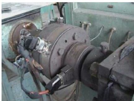
Slika 8. Mašina i alat za izvlačenje cevi
