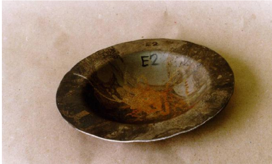
Slika 5. Snimak deformisanog lima sa EMIO postupkom
