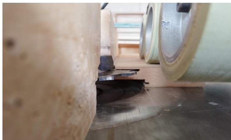
Slika 10. Podešavanje alata šablonom
