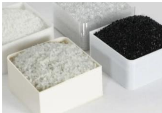
Slika 1. Materijal za FGF postupak 3D štampe [2]
