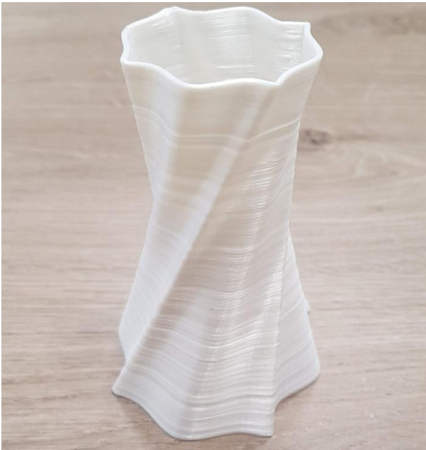
Slika 19. Probni deo oštampan pri testiranju 3D štampača
