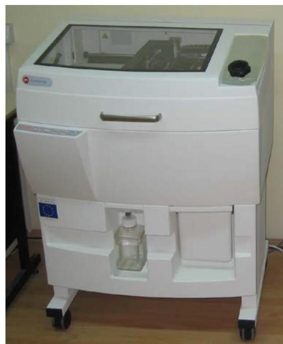
Slika 1. Uređaj za vezivnu 3D štampu Z310 plus
