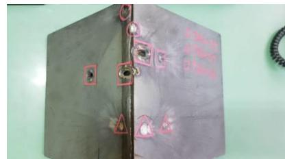
**Slika 6.** Prikaz ispitanog uzorka ugaonog spoja sa ulazne strane [3]
