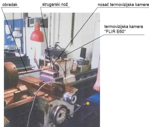
**Slika 3.** Merenje temperature rezanja pomoću termovizijske kamere „FLIR E60“
