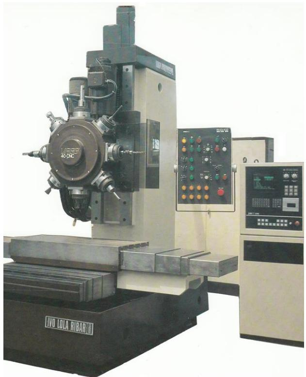
**Slika 9.** Lolina vertikalna bušilica-glodalica VRBG-40CNC sa evolverskom glavom
