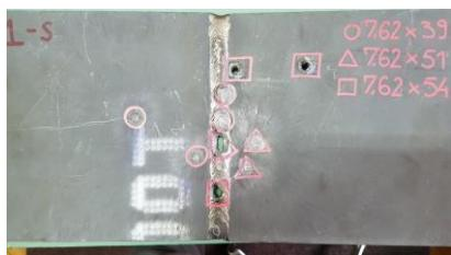
**Slika 5.** Prikaz ispitanog uzorka sučeonog spoja sa ulazne strane [3]
