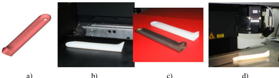
Slika 12. Brzi prototip na bazi FE simulacije i kontrola na CMM:: a) eksportovan STL iz FE simulacije b) RP model u 3D printeru ALARIS 30 c) metalni deo i RP model d) kontrolno merenje na CMM
