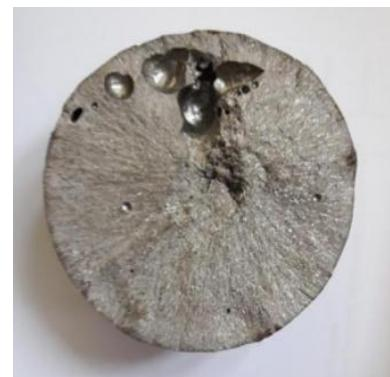
Slika 6. Izgled odlivka - flotacione kugle nakon ispitivanja na udar
