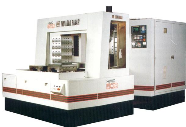
**Slika 15.** Horizontalni obradni centar
