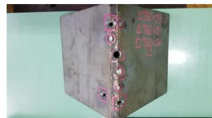
**Slika 7.** Prikaz ispitanog uzorka ugaonog spoja sa zaštitom sa: a) Ulazne, i b) Izlazne strane
