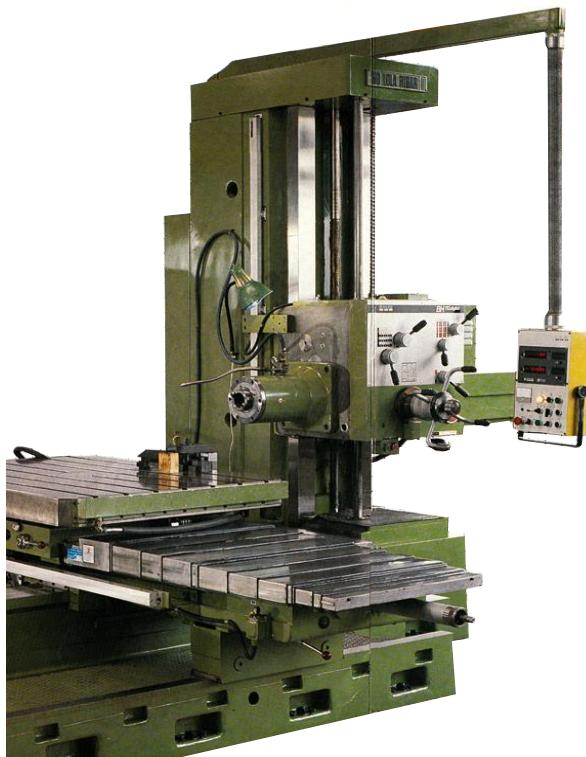
**Slika 5.** Horizontalna bužilica-glodalica HBM 4
