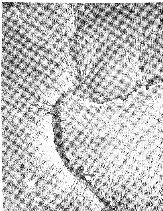
Slika 2 : Frakto=grafija površine prekida koljenaste osovine dizel mo=tor. Ekstruzije, početak pukotine.
